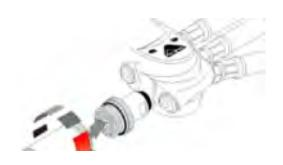
**STEP 8** 2ndステージのL.P.ホースと加湿筒キャップ **FINISH** を接続、加湿筒と接続します。
