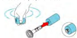
含水フィルターは乾燥していますので、含水 フィルターを異物の混入していない水道水に 浸し、全体的に柔らかくなるまで良く揉みほぐ します。
